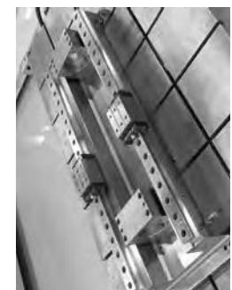
将带有千分表的磁力表架固定在 L 型工装上，将 L 型工装紧贴滑块、测量电机侧与反电机侧各自轴承座附近的丝杠轴侧面，确认“水平方向倾斜”。
